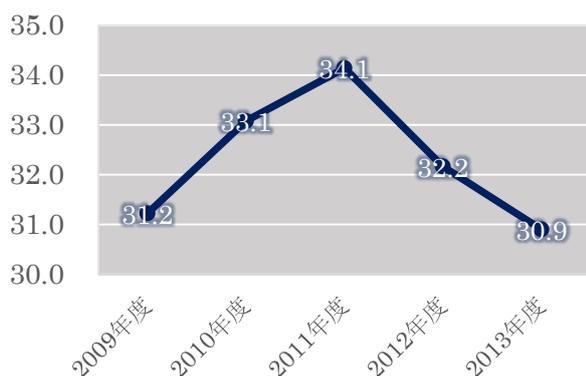
電力使用量は2009年度比で78%と大幅に減少したが、生産重量も79%減少しており、固定的要素を勘案すると、生産重量当りの電力使用量削減は厳しい状況。しかし、高効率機器(コンプレッサー、照明、変圧器等)への設備更新やコンプレッサーの稼働調整等の取組で電力使用量を削減し、目標を達成。
