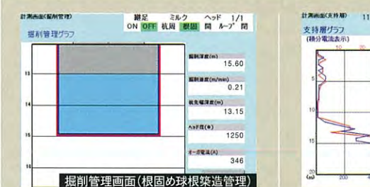
掘削管理画面(根固め球根築造管理)
