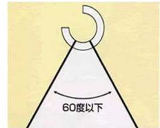
2点吊り時の吊り角度 (60度以下)
