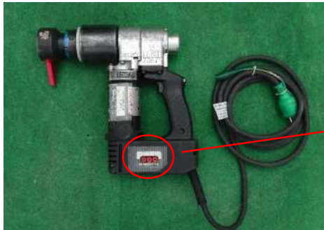
電動トルクレンチ (製品例: トルシャット)
