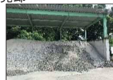
路盤材 再生砕砂、再生砕石 (新規)コンクリートスラッジ
