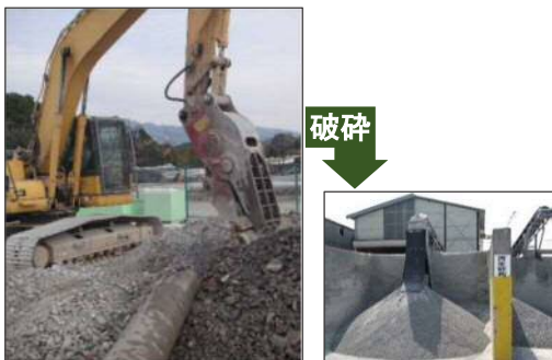
[廃品ポールの破碎処理] [再生砕砂、再生砕石] ○収集した産業廃棄物(廃品ポール)の リサイクル促進
